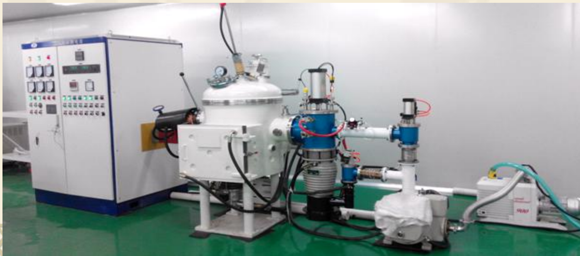
真空感应炉设备示意图和原理图
